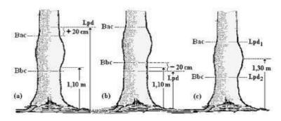
Gambar 6. Pengukuran Pohon Cacat
