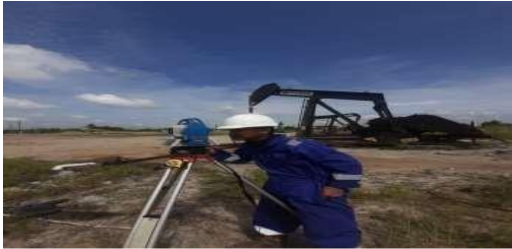
Gambar 12. Pengukuran Topografi Menggunakan Total Station Spectra Focus
