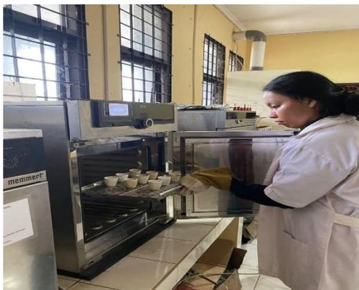
Gambar 6. Pengovenan Sampel Uji Kadar Air
