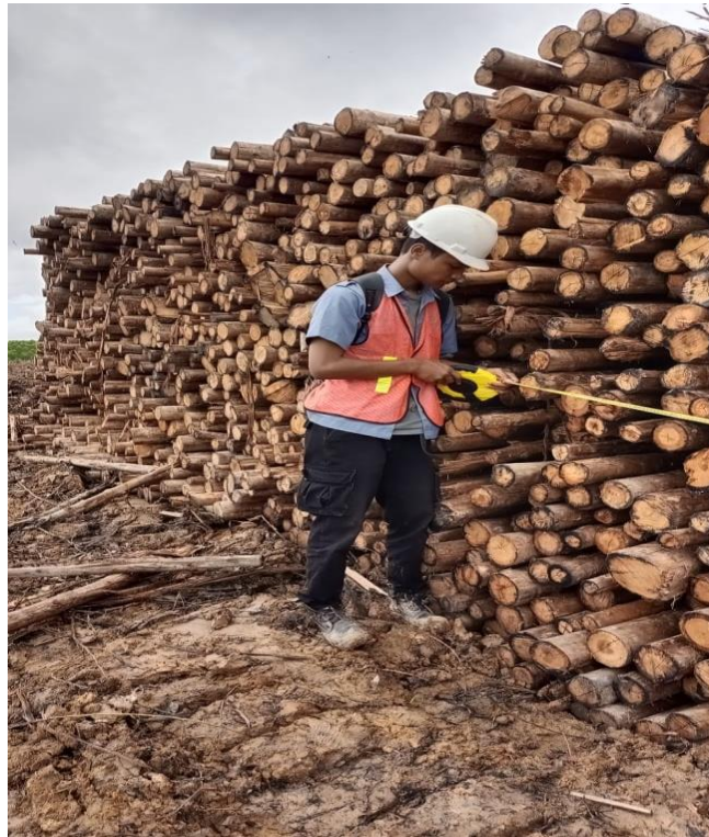
Lampiran 11. Gambar Pengukuran Stapel Meter
