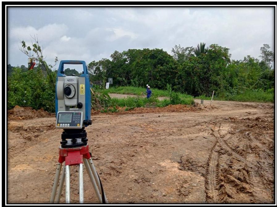
Gambar 6. Instrumen Pengukuran Topografi
