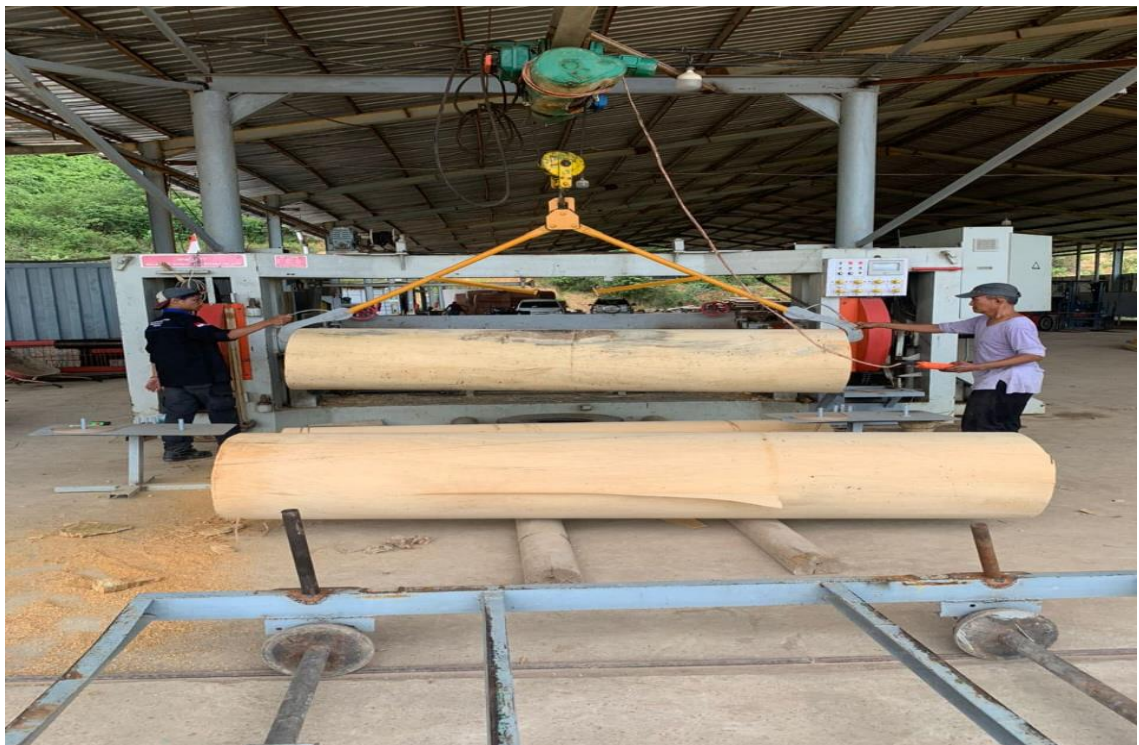
Lampran 12. Pengangkatan Log Menggunakan Hoist
