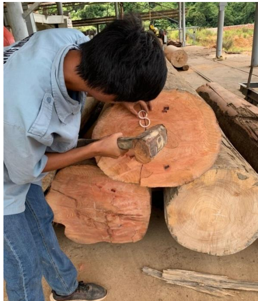
Gambar 16. Pemasangan Paku S
