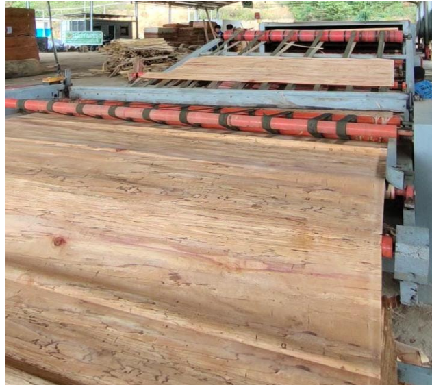
Gambar 7. Pemotongan Veneer di Mesin Clipper
