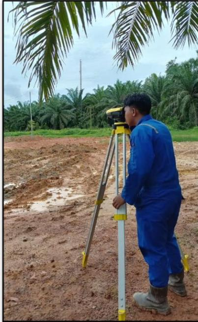
Gambar 5. Pengukuran *Levelling*
