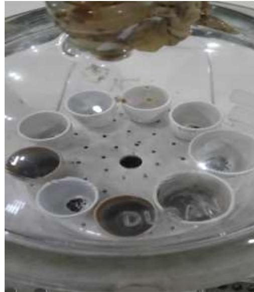
Gambar 25. Dinginkan Sampel Dalam Desikator
