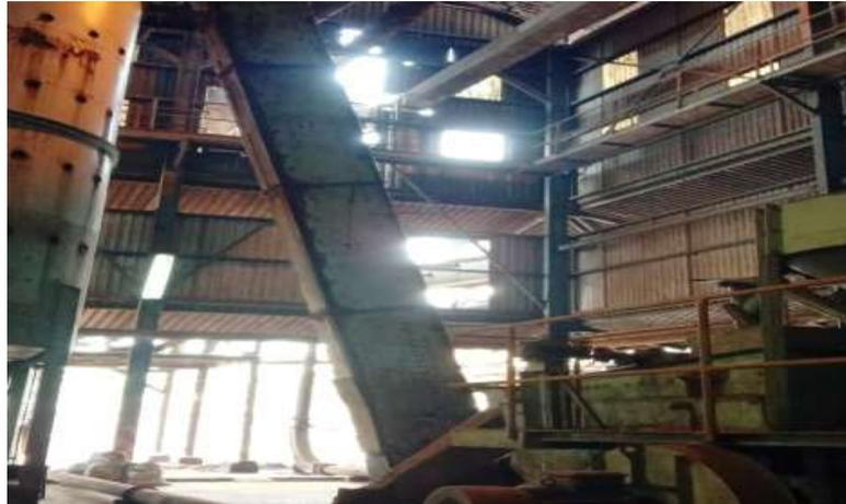
Gambar 27. Wet Kernel Elevator
