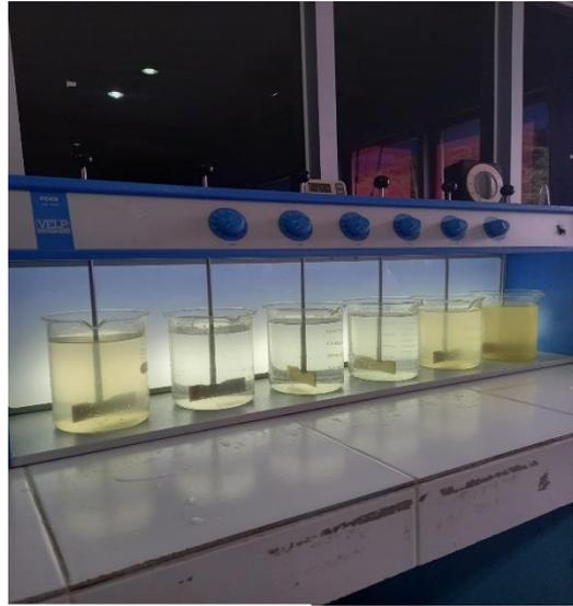
Gambar 6. Proses Flok-Flok, setelah 15 Menit.
